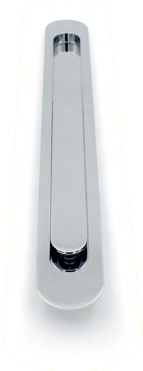
Flächenbündig einzulassender Hebe-Schiebetürgriff der komplett in der Muschel verschwindet und dort über einen Magneten gehalten wird. Zur Betätigung wird der Griff heraus geklappt, wodurch alle gängigen Systeme bedient werden können.
